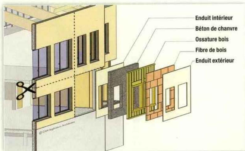
La structure du bâtiment Triballat à Noyal-sur-Vilaine (35), conçu par Can-IA, est constituée d'une structure primaire mixte bois/béton, sur laquelle a été rapportée une enveloppe en murs-rideaux ossature bois et remplissage béton de chanvre préfabriquée par LB Eco Habitat.
