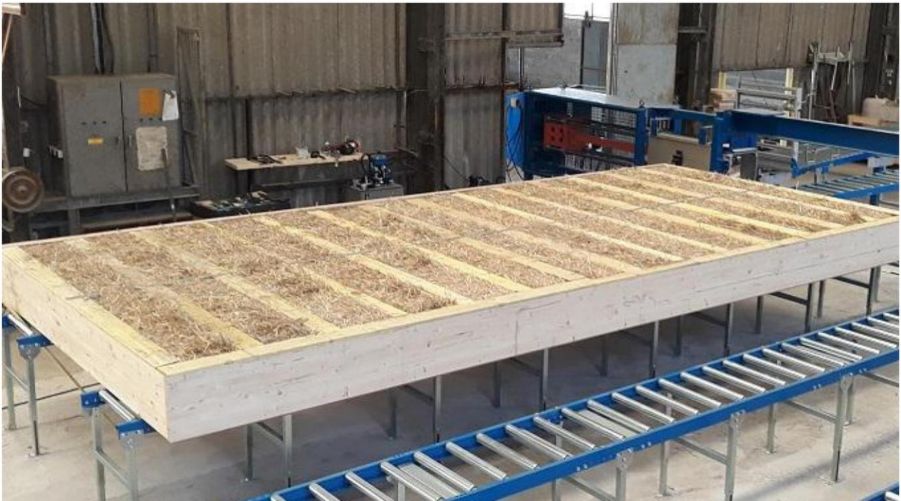
Comme ici chez Activ Paille à Itancourt (Aisne), les murs en ossature bois contenant de la paille sont de plus en plus fréquemment préfabriqués et industrialisés en atelier, d'où un gain de temps sur la durée des chantiers et une diminution considérable du prix des bâtiments.
