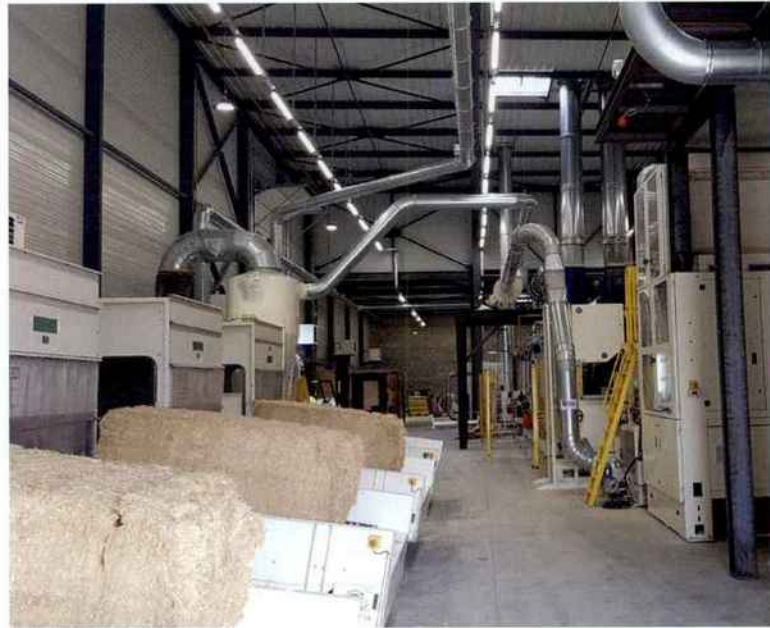
L'usine FBT transforme depuis début 2020 la paille de riz de Camargue en panneaux. Performants en thermique et acoustique, les isolants biosourcés sont aussi imbattables sur leur confort de pose et leur bilan environnemental.
