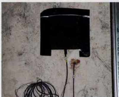
80 capteurs observent en permanence le comportement des parois et des isolants biosourcés.
