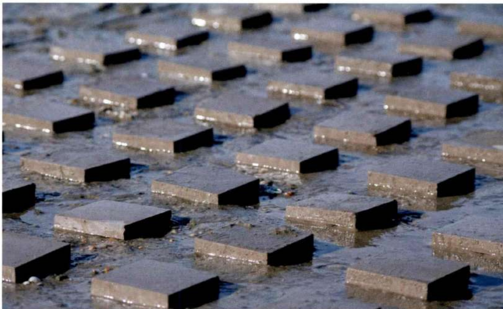
② Le procédé de fabrication sans cuisson permet de solidifier les sédiments marins et de les mouler à la forme souhaitée.
