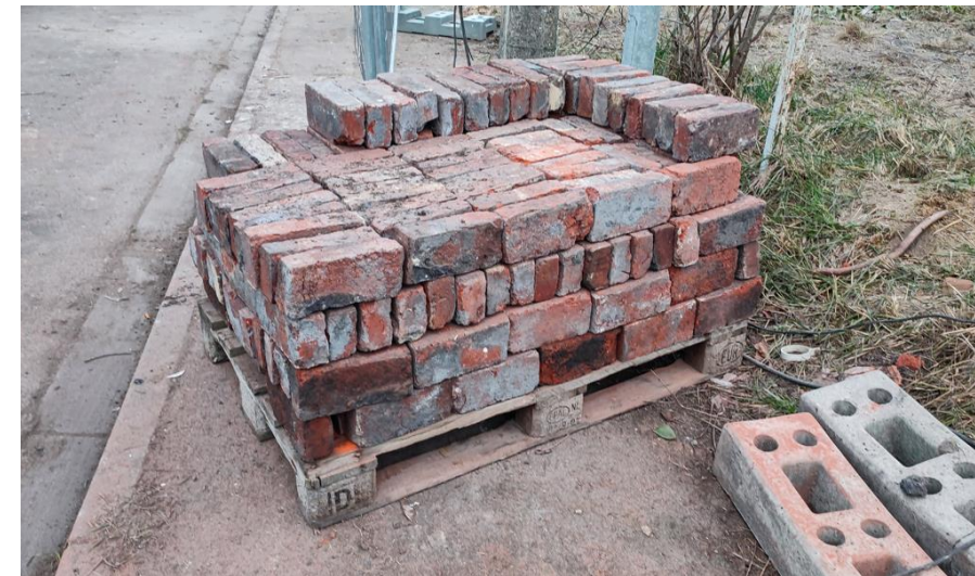
Briques mises sur palette après déconstruction (crédit photo : Maisons et Cités)
