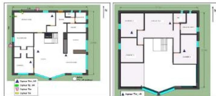
Figure 3.7 : Plan d'instrumentation du rez-de-chaussée et du 1er étage.
