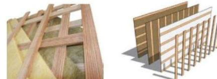
Un treillis structural en lames de bois croisées à 90° + Un remplissage isolant collé et jointif sur la structure bois
