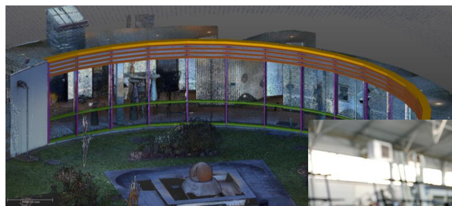
Relevé 3D en nuage de point de l'existant et interfaçage du modèle de conception
